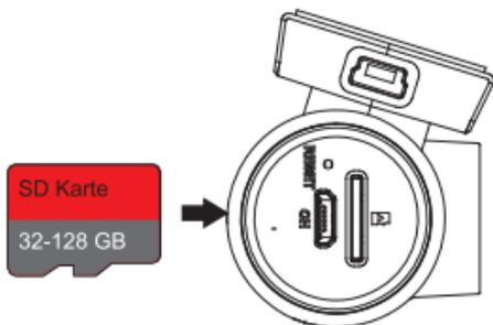
Verwenden Sie nur Speicherkarten mit einer Speicherkapazität von 32- 128GB. Lassen Sie die SD-Karte zum Formatieren in der Dashcam. Öffnen Sie die DC2 App auf dem Smartphone und starten von dort unter Einstellungen die Formatierung. Alternativ kann die Formatierung auch durch 5x drücken der Taste an der Kamera gestartet werden.
