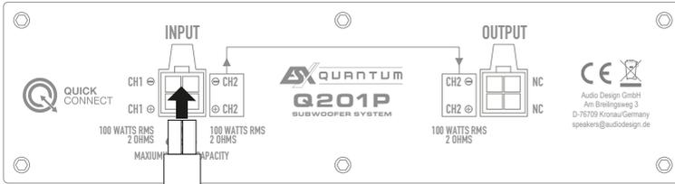
Das violett-schwarze und violette Kabel ist in diesem Anschlussbeispiel ohne Funktion. Beide werden nur dann benötigt, wenn ein weiteres Subwoofer-System an **OUTPUT** angeschlossen wird (siehe unten). Isolieren Sie die beiden losen Kabelenden sicherheitshalber.
