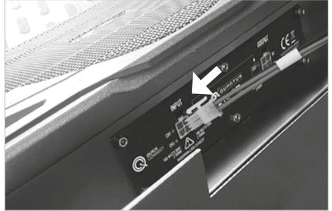
Schließen Sie alle benötigten Anschlusskabel wie aus Seite 3 und 4 beschrieben am Subwoofer-System an.
