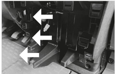
Entfernen Sie dann den Konsolenträger und legen diesen beiseite.
