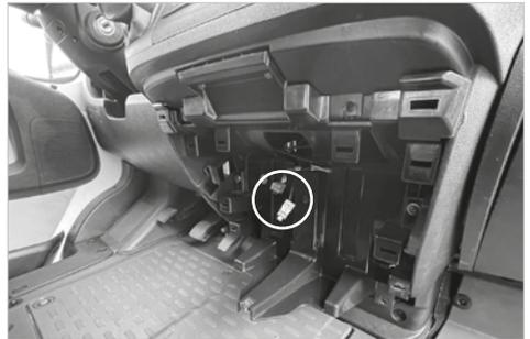
Ziehen Sie falls vorhanden die beiden Anschlussstecker an der Konsole heraus und entfernen diese komplett.
