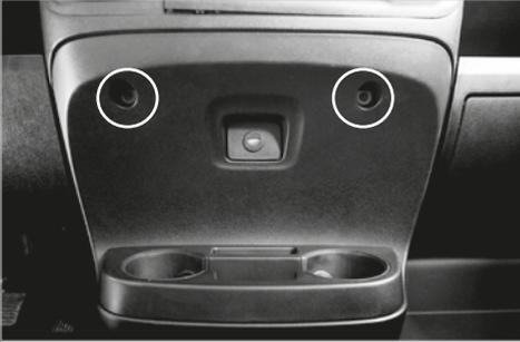
Lösen Sie die beiden Schrauben (Torx T25) oberhalb des Getränkehalters.
