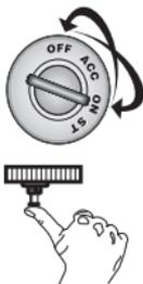
Drehen Sie die Zündung auf EIN, dann auf AUS. Drücken und lösen Sie den Service-Taster kurz innerhalb von 10 Sekunden. Die LED wird durchgehend aufleuchten, wenn Sie den Service-Modus erreicht haben, und sie wird erlöschen, wenn Sie den Service-Modus verlassen haben.
