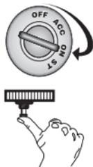
Schalten Sie die Zündung auf EIN. Drücken und lösen Sie den Service-Taster innerhalb von 10 Sekunden. Nach einigen Sekunden wird die LED nicht mehr blinken und das Fahrzeug sollte starten. Wenn das nicht geschieht, dann haben Sie zu lange bis zur Betätigung des Schalters gewartet, schalten Sie die Zündung aus und versuchen Sie es erneut.
