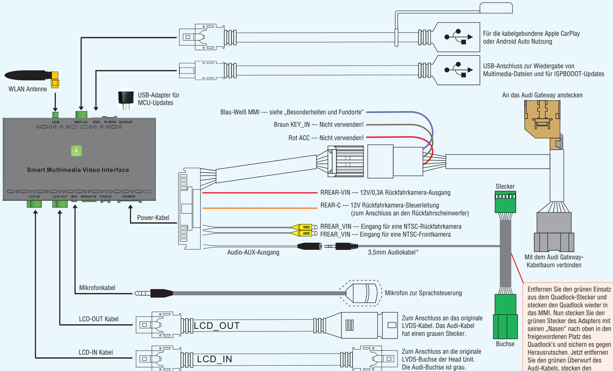
\*Bei Fahrzeugen mit MMI 3G+ und Audi Music Interface (AMI) muss zusätzlich das Kabel Ampire LDS-AMI-AUX35F verbaut werden. Andernfalls ist eine Töneinspeisung nicht möglich!
