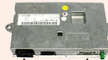
Anschlussstecker, das Blau-Weiße MMI-Kabel an PIN 16 anschließen
